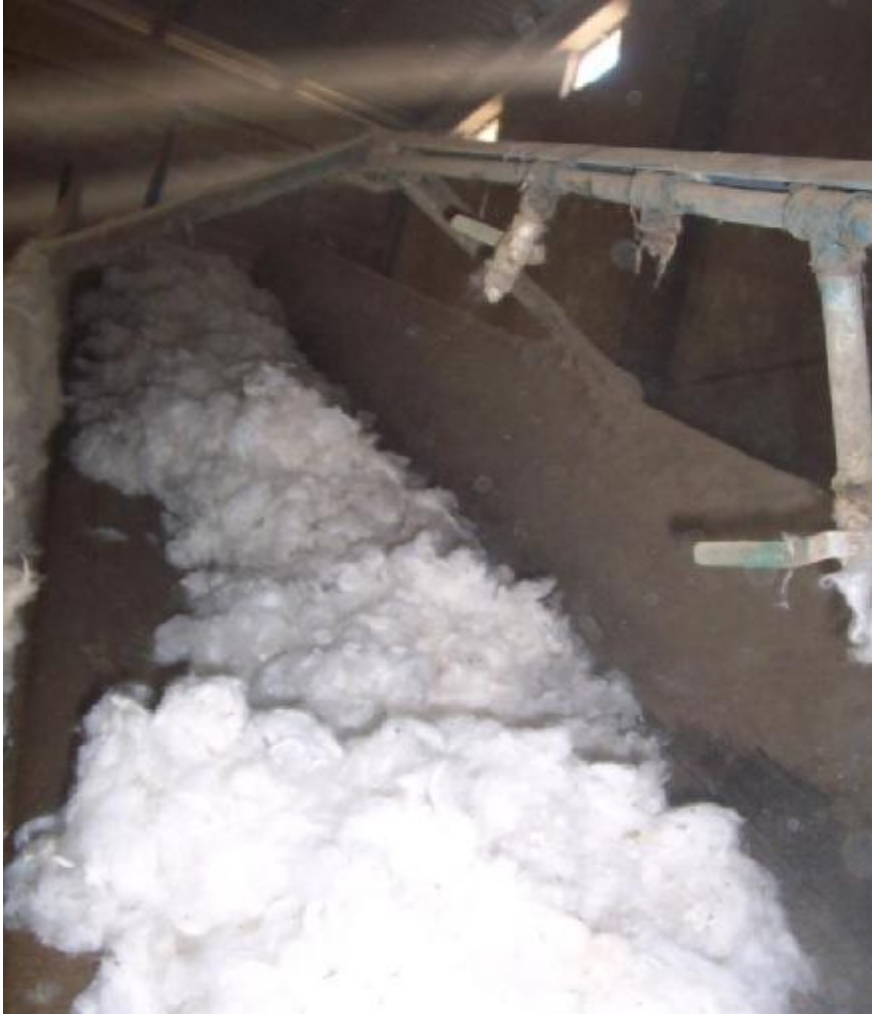
Şekil 4.5. Rollergin tipi çırçır makinesinden çıkan pamuğun rutubetlendirilmesi işlemi
