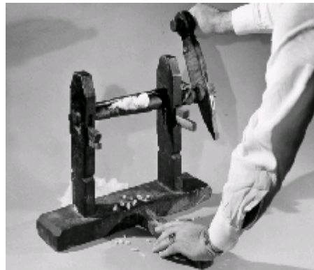
Şekil 2.1. El ile çalışan churka veya jerka diye adlandırılan çırçır makineleri
