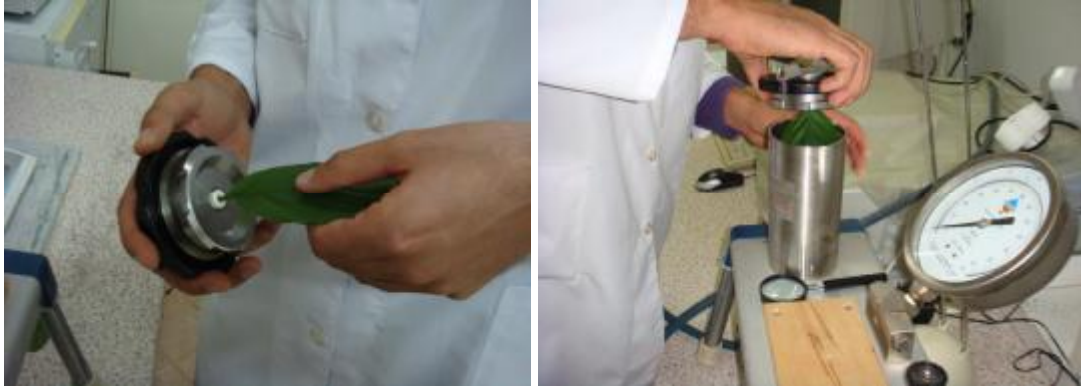
Şekil 3.7. “Yaprak Su Potansiyeli”nin belirlenmesinden bir görünüm
