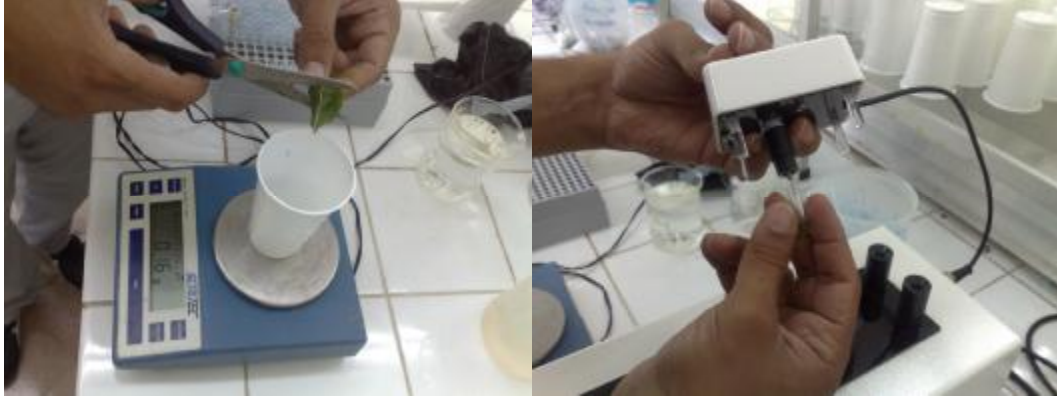
Şekil 3.8. "Yaprak Ozmotik Potansiyeli"nin ölçümünden görünüm
