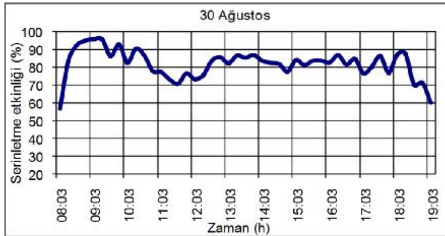
Şekil 4.12. III. ölçüm gününde ped serinletme etkinliğinin zamana bağlı değişimi
