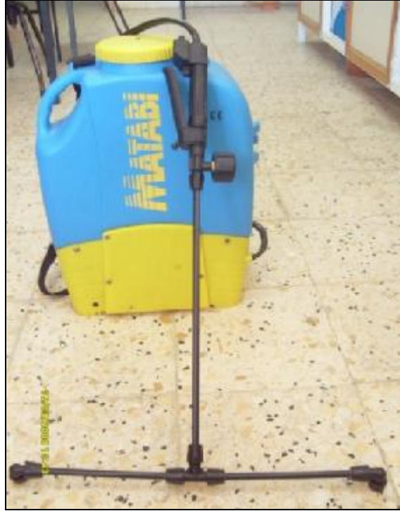
Resim 3.4. Denemelerde herbisit uygulamasında kullanılan sabit basınçlı deneme pülverizatörü.
