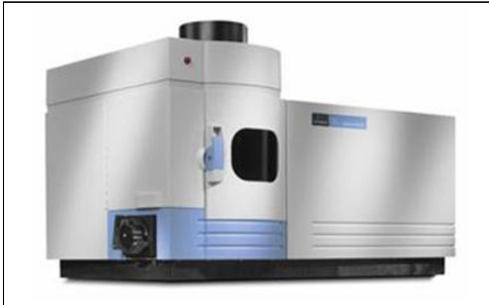
Şekil 3.4 Perkin elmer marka optik emisyon spektrometre cihazı
