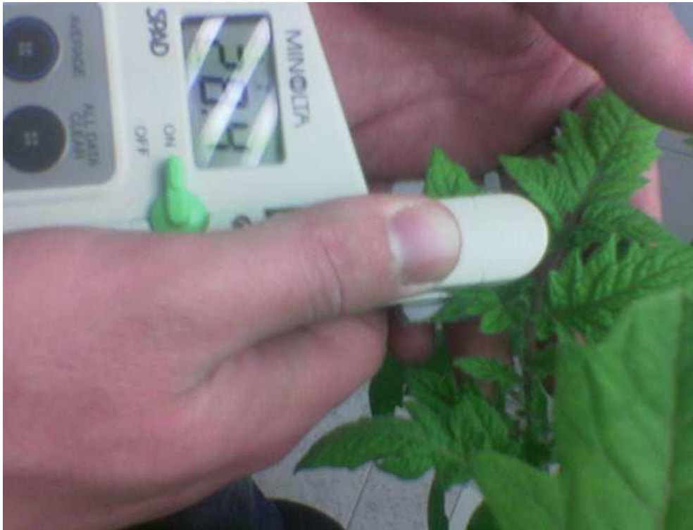
Resim 3.11. Domates Genotiplerinin Yapraklarında Minolta Klorofil Metre (SPAD-502) Kullanılarak Kloroz Seviyesinin Belirlenmesi.
