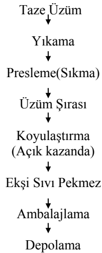
Şekil 3.3. Ekşi sıvı pekmez üretim aşamaları
